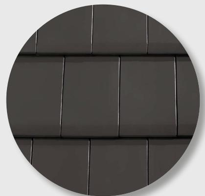
Kann in Verbandsdeckung ab 10° Dachneigung mit einem wasserdichten Unterdach verlegt werden.
