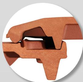
\* La possibilité de déplacement d'environ 29 mm intégrée dans l'emboîtement de tête et de pied confère un maximum de flexibilité et facilite les opérations de couverture pour tous les projets de rénovation et de construction.
